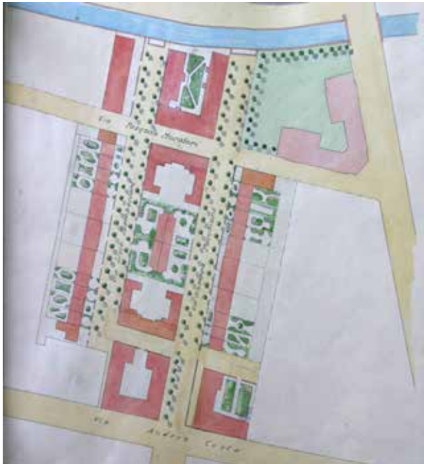
Schema planimetrico dell'ing. Giuseppe Lambertini, progetti di casamenti a corte e in linea, 1887 con intitolazione delle strade. 1 © Bologna, Cooperativa Risanamento.
